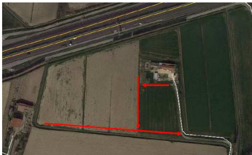
Le frecce indicano gli interventi infrastrutturali proposti, ovvero la creazione di due nuove scoline
